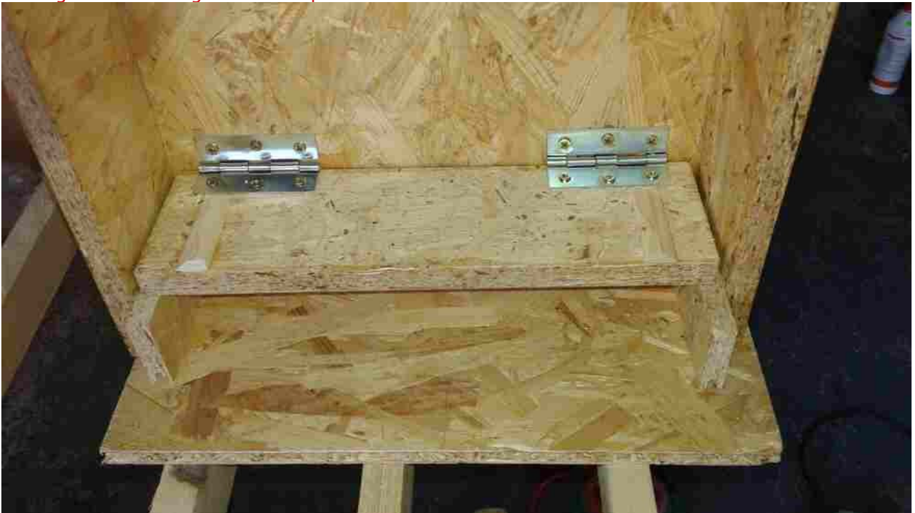
Montage der Rollträger Platte mit passenden Abstandshaltern
