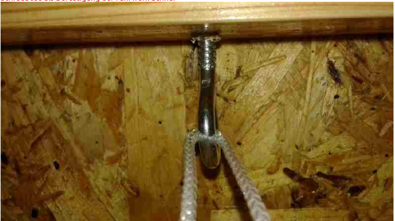
Schrauböse als Befestigung der Fahrwerk-Schnur
