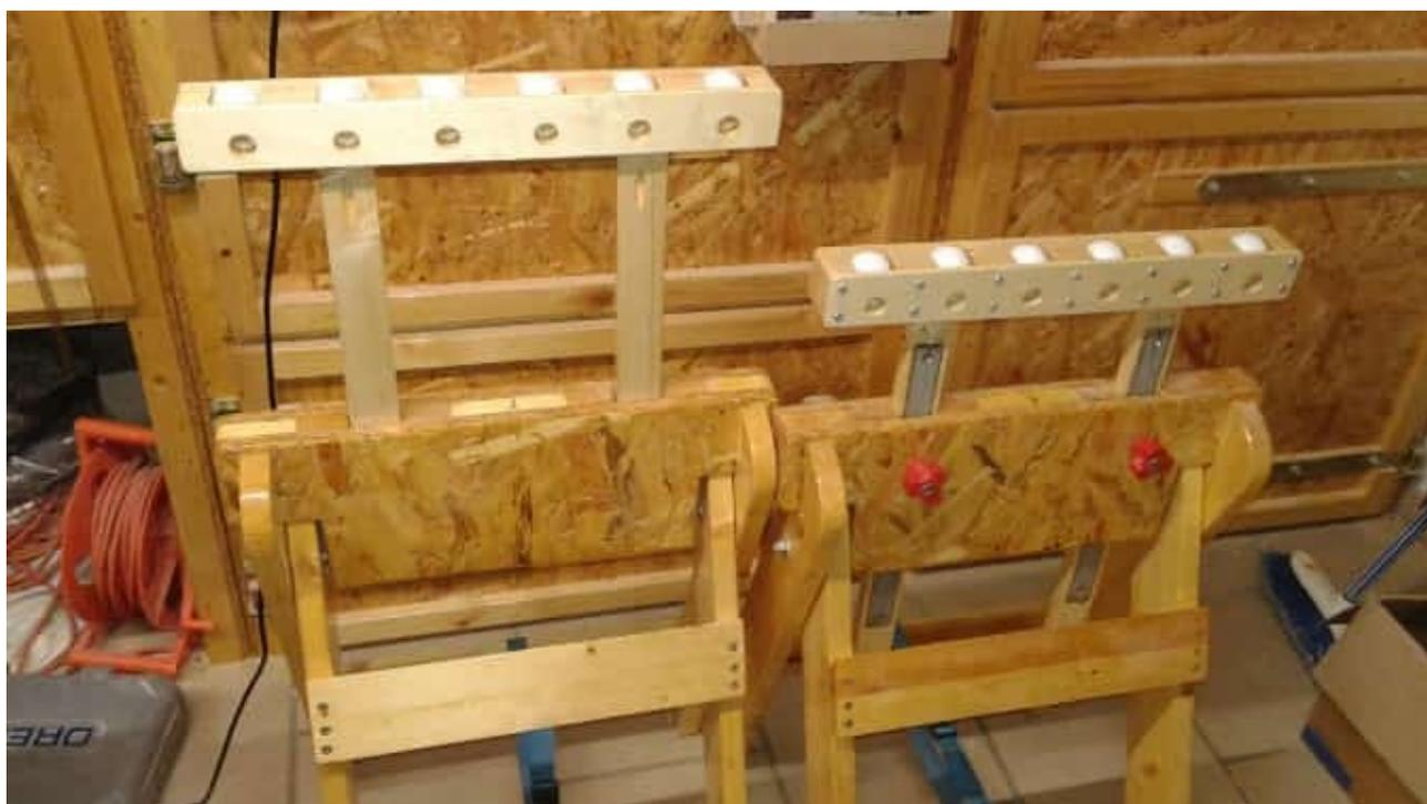
Die Kugelstützen fertig zum Einsatz
