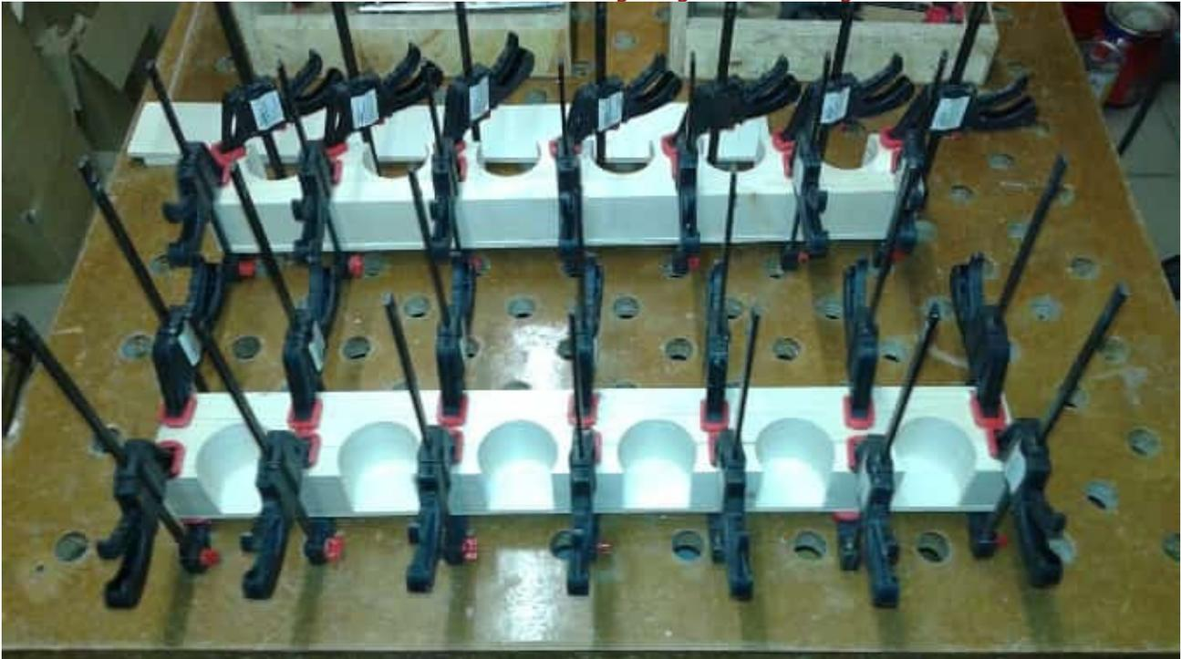
Da die Seitenwände absichtlich mit etwas Übermaß zugeschnitten waren wurden sie jetzt noch auf dem Bandschleifer auf Maß geschliffen und gleich auch alle Kanten gebrochen.
