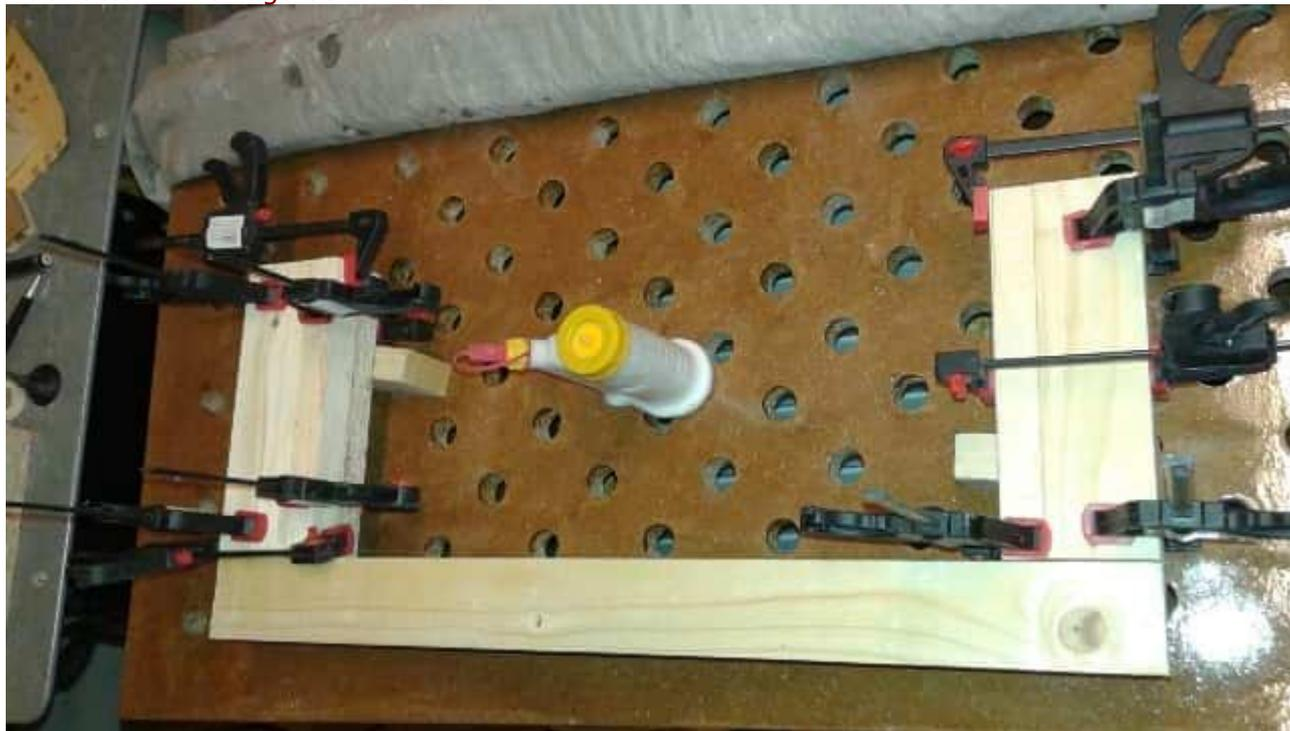
Der „Einlegebalken“ ausgerichtet auf der Arbeitsplatte zum Verleimen der Seitenwände.
