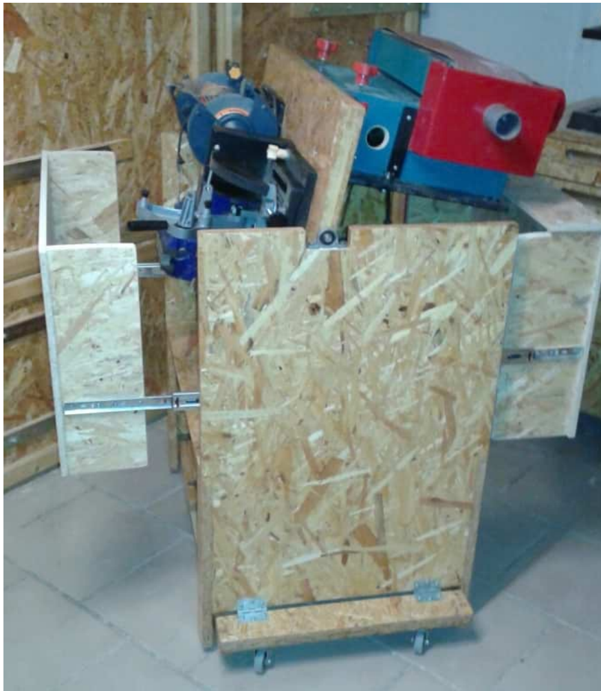
Drehen der Arbeitsplatte. Die Stützen sind hierzu fast voll ausgezogen.
