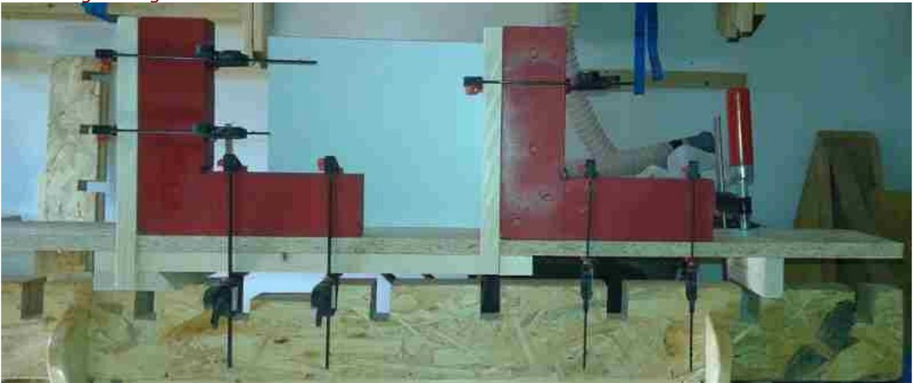
Schrauben zur Sicherung. Oben gerade rein (links), unten Pocket Holes (rechts).
