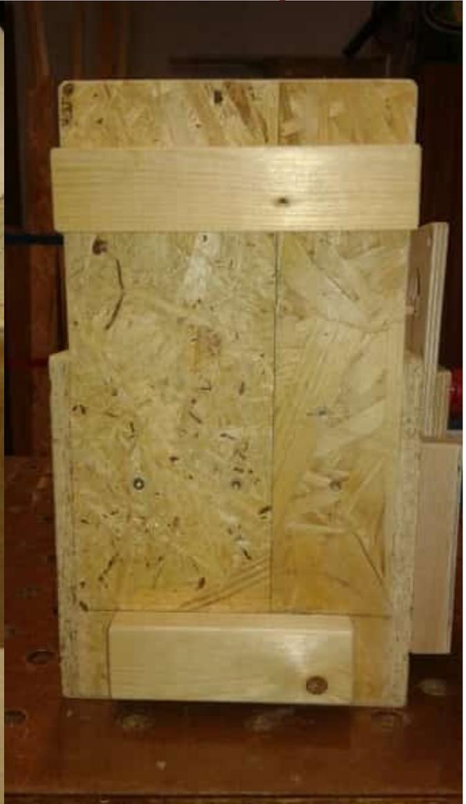
Detail: Halter für den Gabelschlüssel
