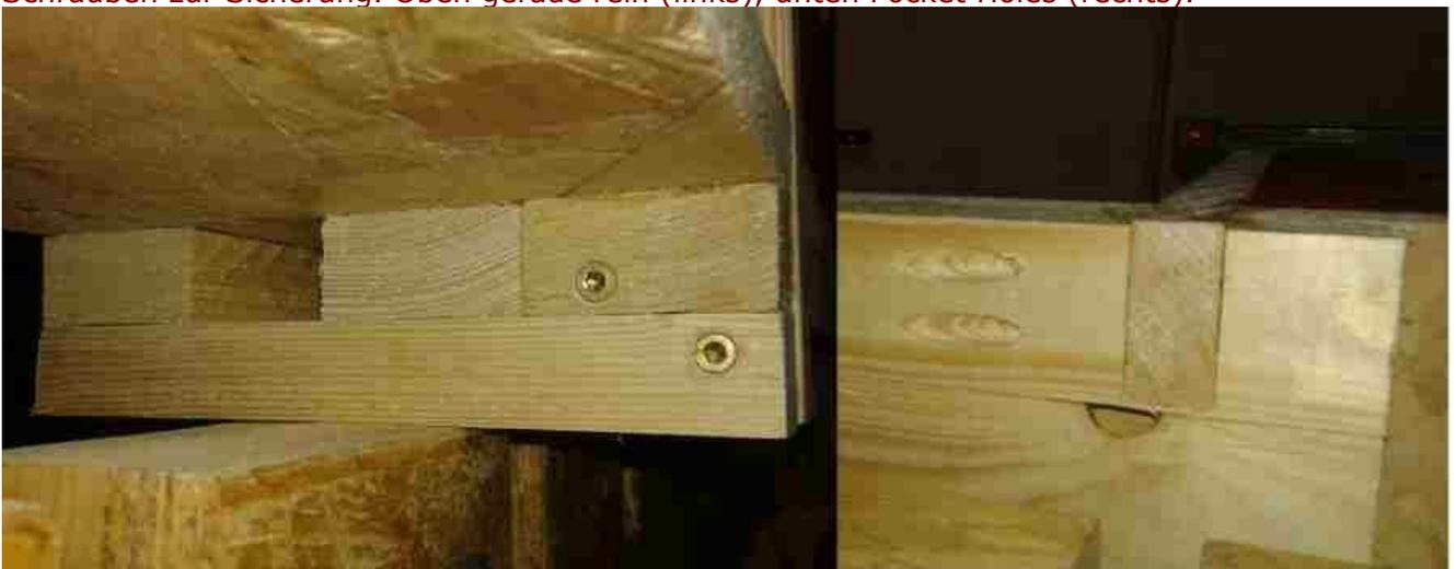
Nichts geht ohne Eckwinkel. Die Seitenwände der Box sind aufgeleimt.
