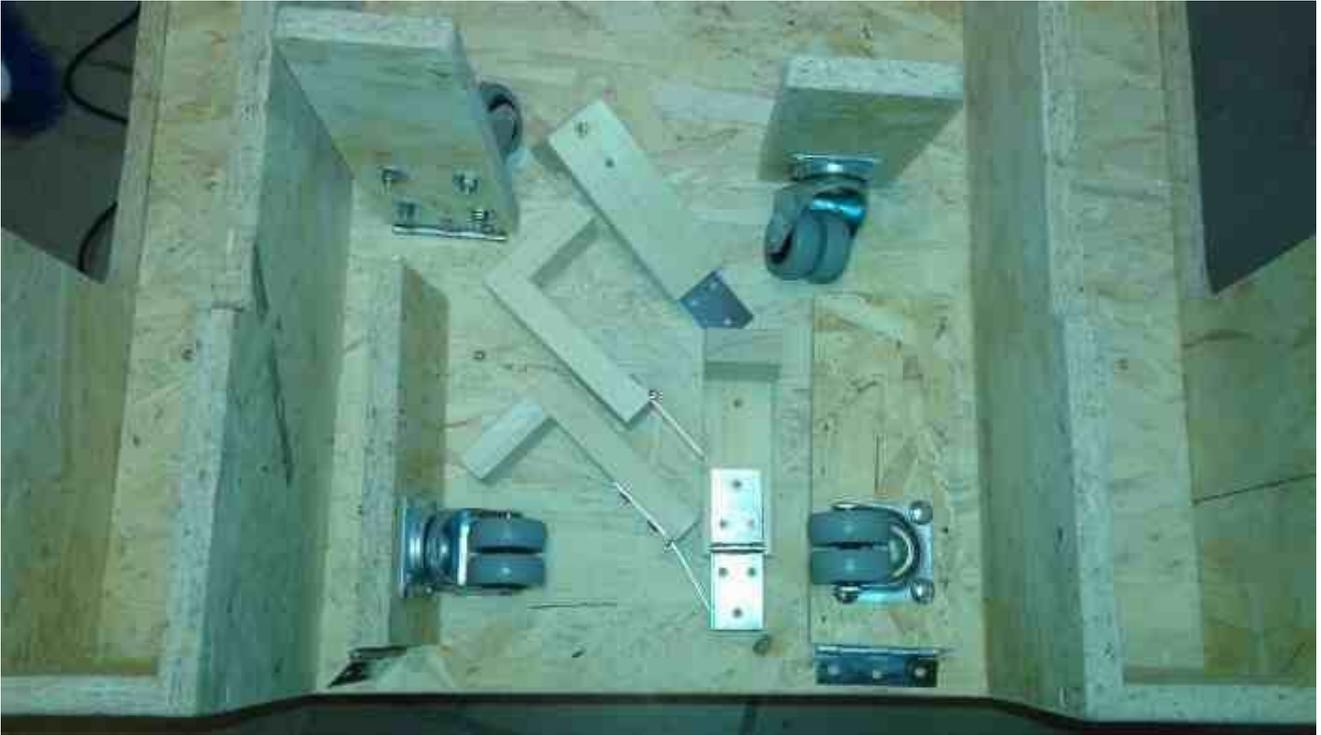
Einziehfahrwerk eingebaut. Steht noch über Kopf aber links ist die Stellung bei verriegelt und rechts abgesetzt.
