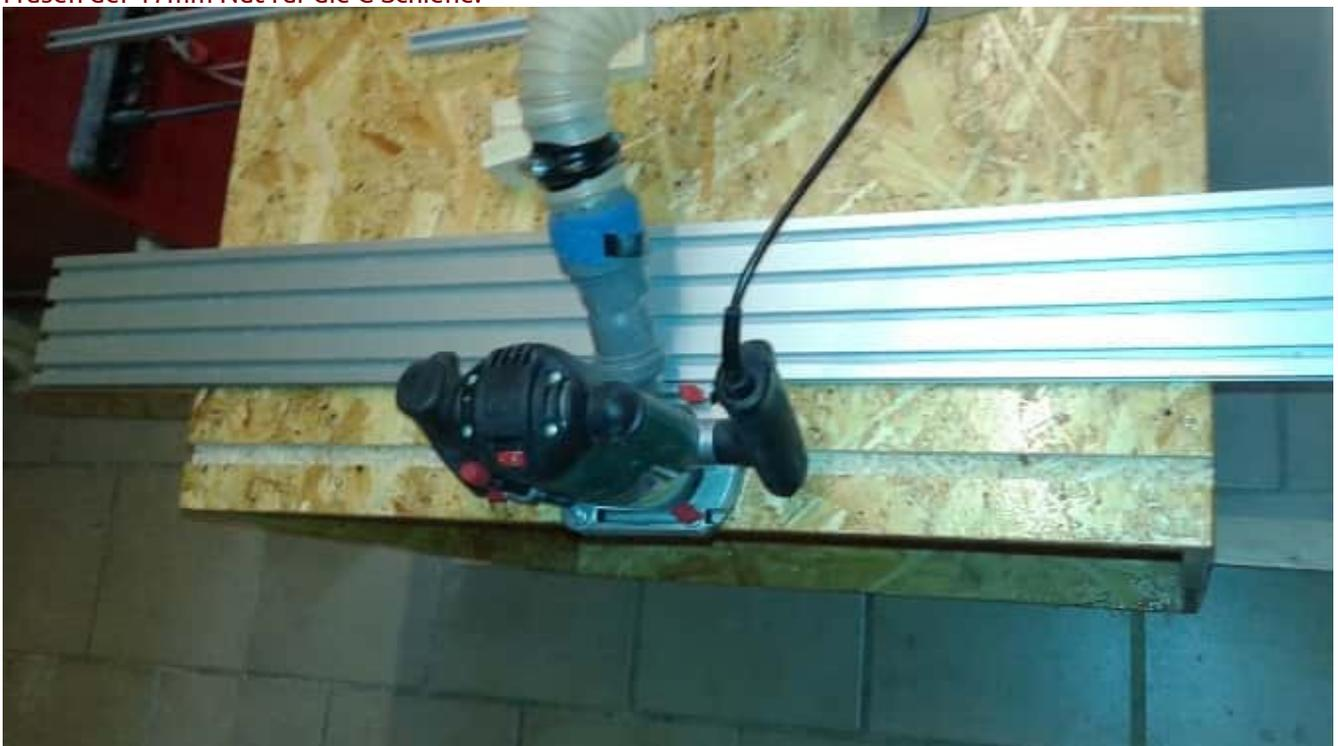
C-Schienen mit Epoxy eingeklebt und zusätzlich noch verschraubt.
