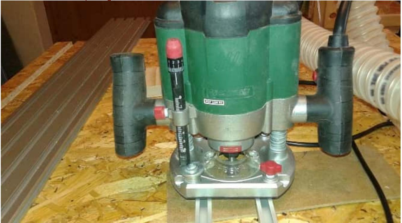
Fräsen der 17mm Nut für die C-Schiene.
