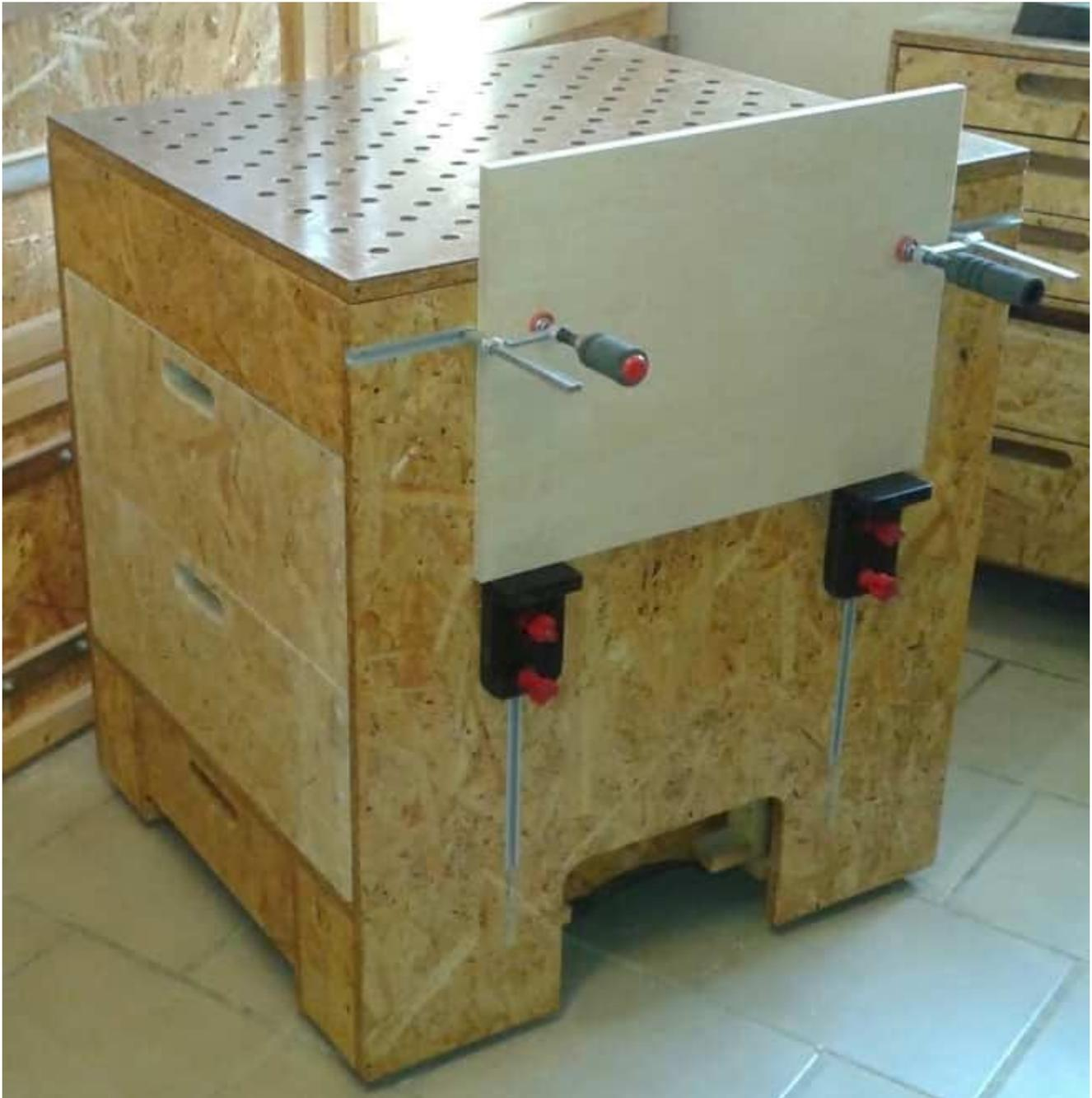
Die vertikale Spannvorrichtung und endlich Schubladen!
