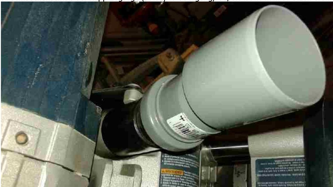
Beispiel: Schlauchanschluß für die Hobelmaschine (59mm auf 50mm). Extra geputzt!!!
