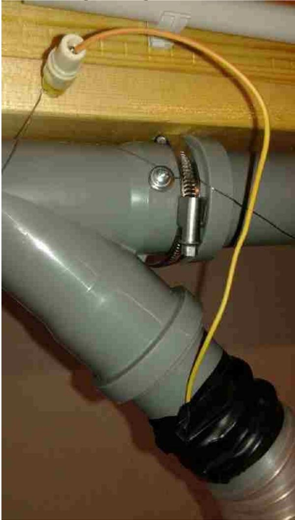
Erdverbindung Rohr zu Saugerschlauch
