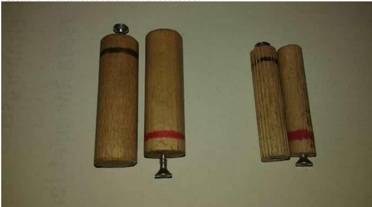
Zwei AAA-Ersatz eingebaut in die Wetterstation mit 3V Netzteil und Kabel mit Heißkleber festgelegt aber NICHT mit der Wetterstation verklebt
