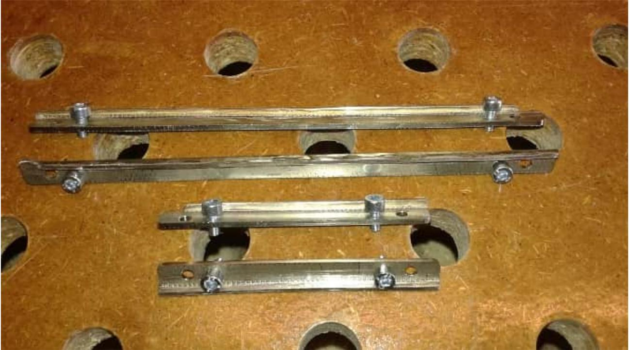
Aus zwei 155mm Zwingen wird eine 480mm Langzwinde und aus zwei 100mm eine 270mm Variante (beliebig mischbar).
