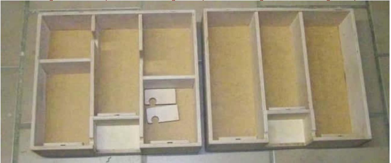
Damit die Sachen nicht alle zueinander fallen gab es noch aus HDF Innenabdeckungen. Diese wurden mittels Klavierband und M3 Schrauben (am Deckel) und 2,9\*6,5mm Blechschrauben (am Boden) befestigt und erhielten wie auch beim "Schaumkoffer" Klettband als Verschuß
