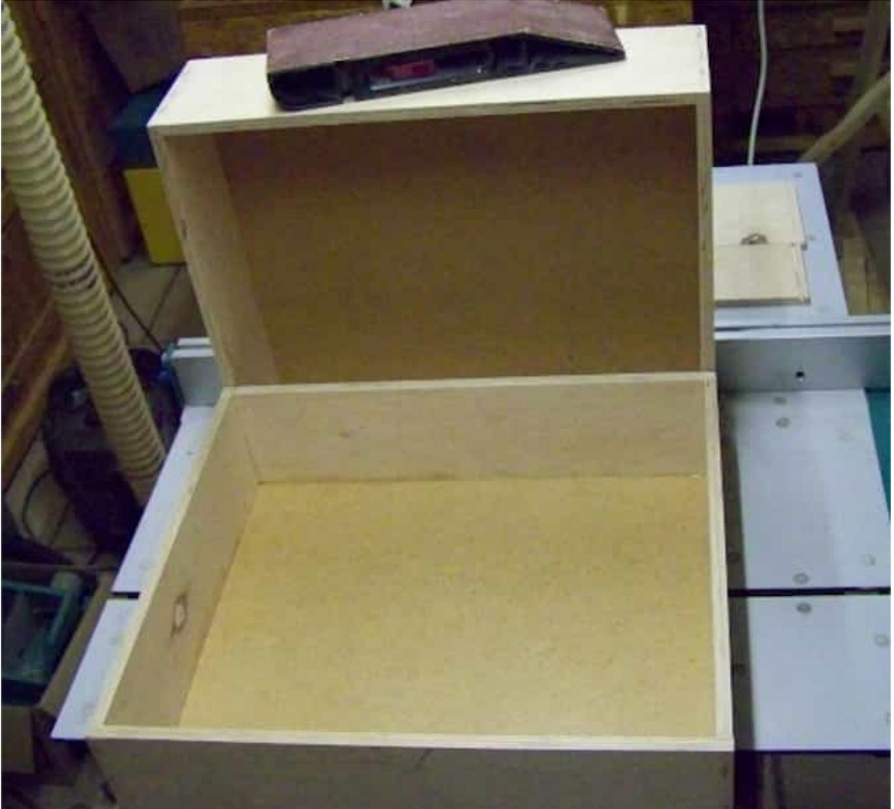
Beim Tackern der Drahtnägel muß man bei dem dünnen MPX aufpassen! Genau auf der Mitte ansetzen, schön senkrecht zur Stirnfläche in der der Nagel enden soll und parallel zur Oberfläche halten. Und natürlich keine Nägel dort wo nachher aufgetrennt wird.
