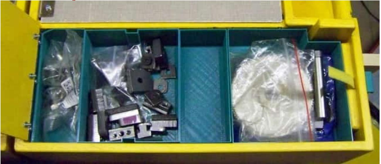
Bei den Boxen habe ich auch probiert ob man den Vasenmodus auch austricksen kann und eine Trennwand rein bringt. Ein "Schnitt" mit 0,02mm Dicke von beiden Seiten mit 1,6mm Abstand in der Mitte und um 1,2mm von der Unterseite weg. Dann wird auf jeder Seite des Schnitts beim slicen eine Wand gezogen und da das direkt daneben ist verkleben die sich beim Druck. Macht man den Schnitt nur 0.01mm breit wird das von Cura ignoriert und es gibt keine Wand.
