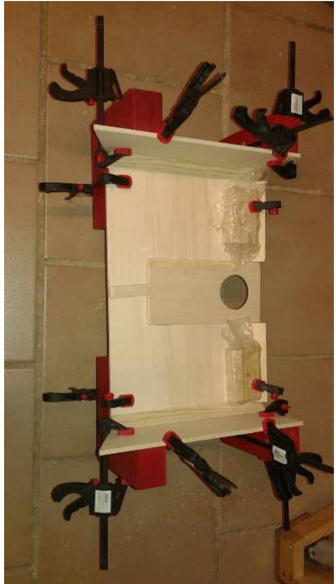
Seitenwände verleimt. Und wieder sind die Eckwinkel im Einsatz
