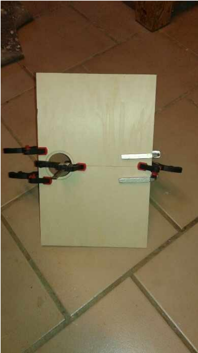
Obere Platte mit Bohrungen verleimt
