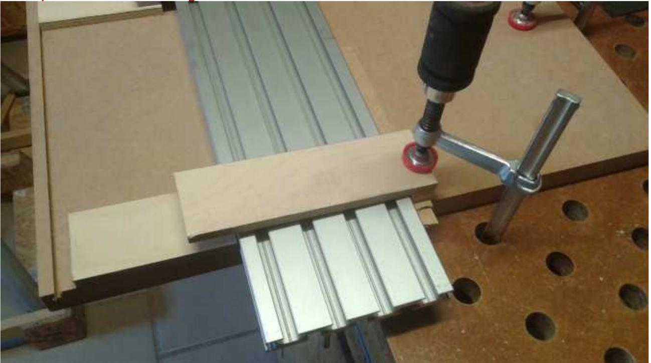
Die Zeiger auf der Platte mit eingesägter Rille aufgespannt und Aufsetzen der Zeigerhalter
