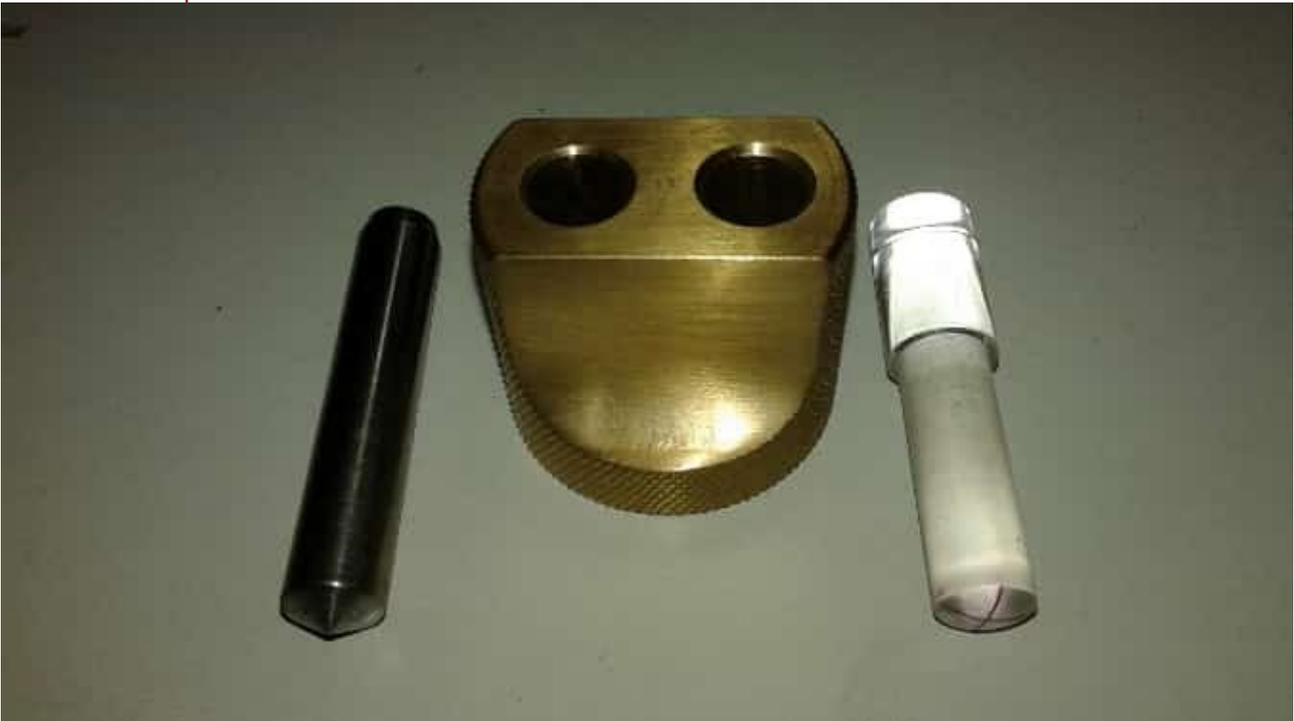
Die Optik wird in die durchgehende Bohrungen des Grundkörpers gesteckt. Dieser wird dann auf die Markierung des Werkstücks aufgesetzt und die Zentriermarkierung in der Optik genau auf den Anriß ausgerichtet. Nun den Grundkörper gut festhalten, die Optik durch den Körner ersetzen und diesem mit einem Hammer einen Schlag verpassen. Nein, nicht auf die Finger sondern auf den Körner schlagen!
