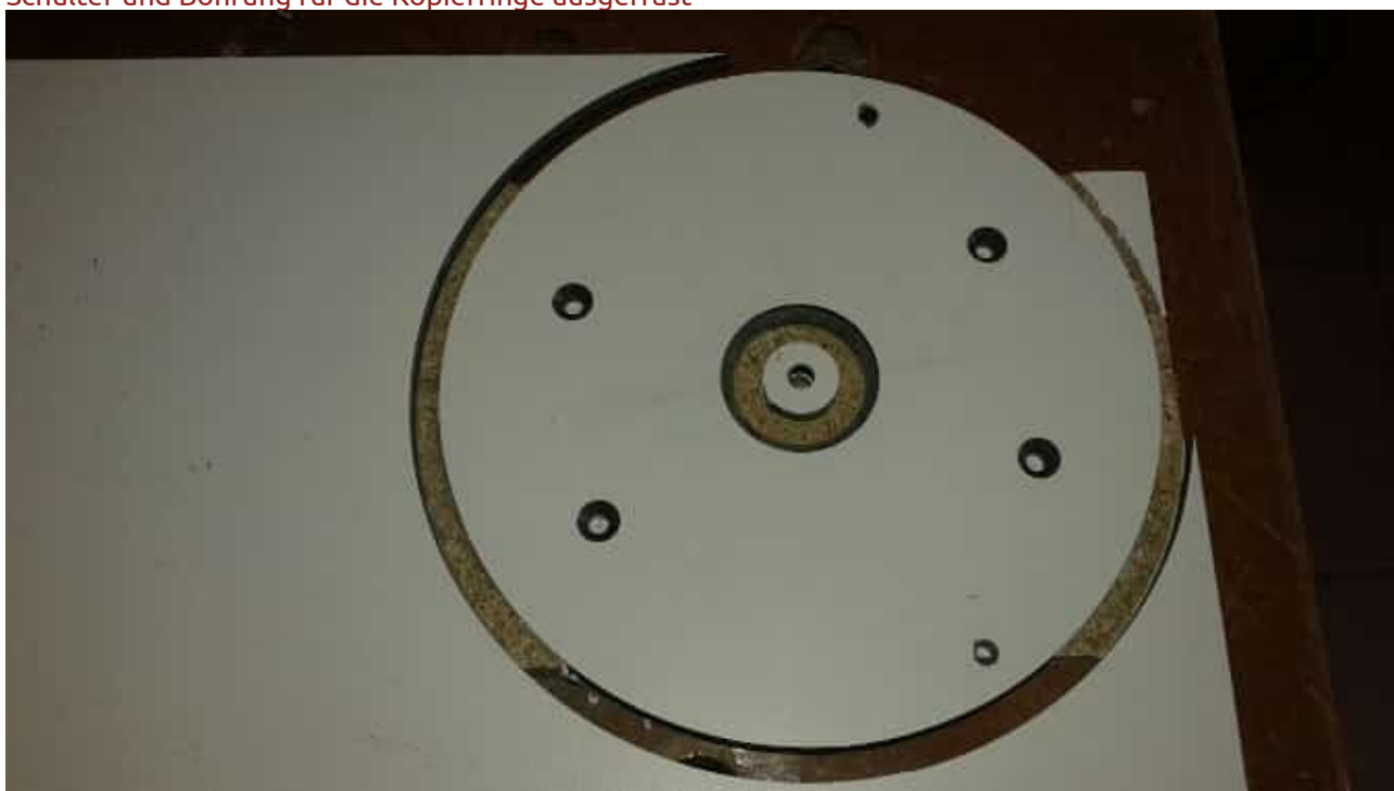
Schulter und Bohrung für die Kopierringe ausgefräst
