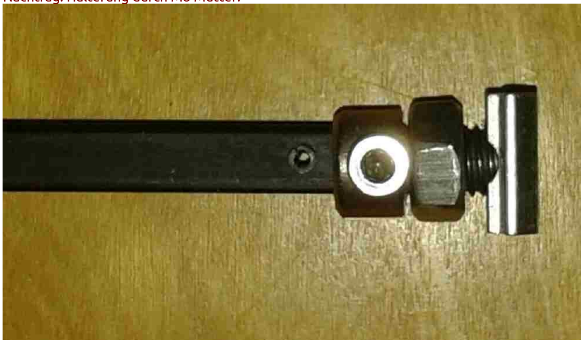
Nachtrag: Halterung durch M8 Mutter:
