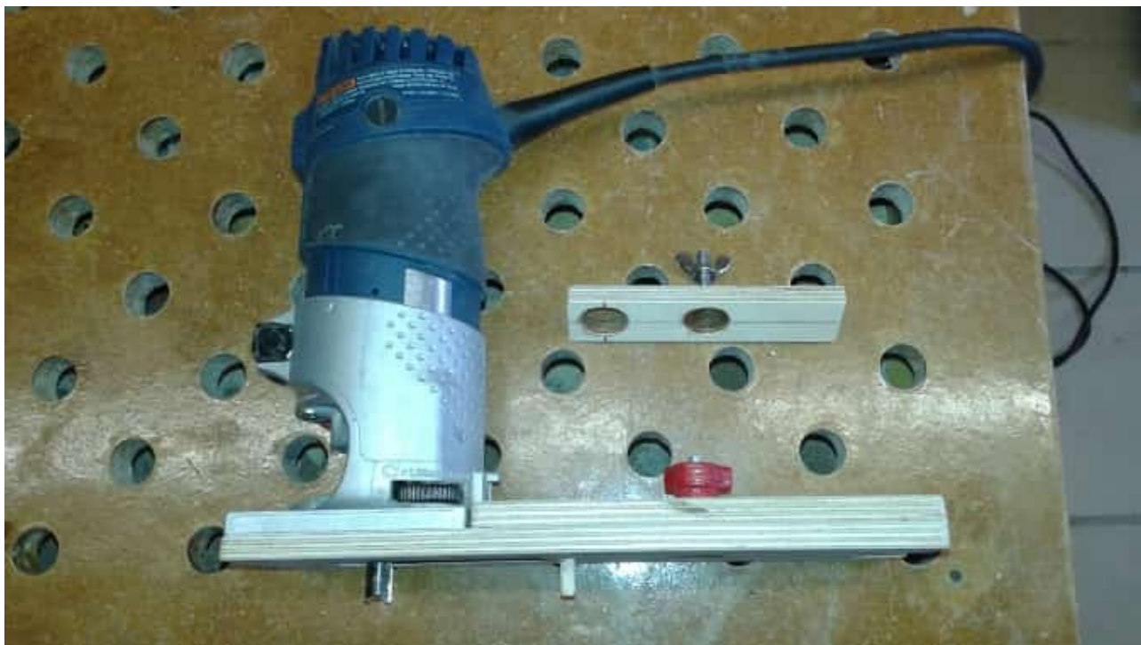
Kantenfräse mit montierter Kreisfräsvorrichtung
