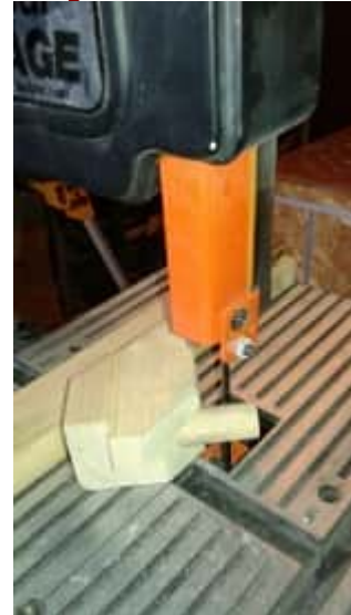
45° Bandsägen-Zuschnitt mit Hilfshalter.
