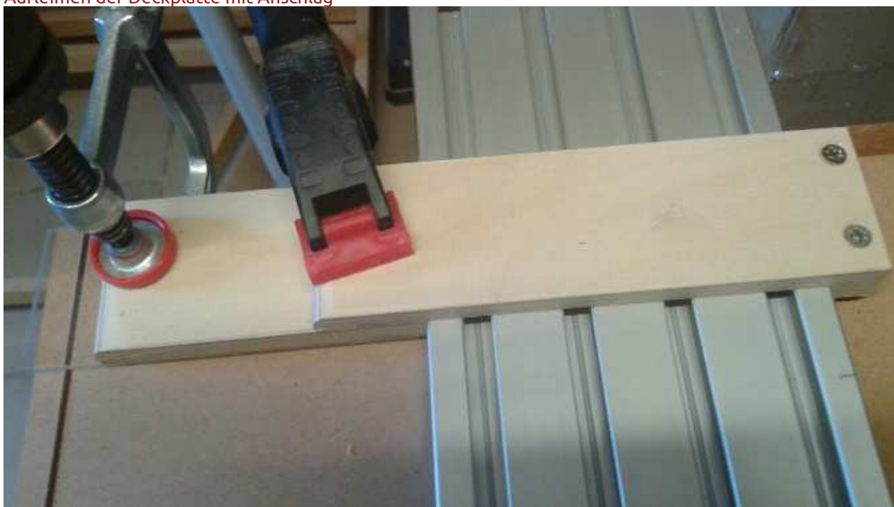
Aufleimen der Deckplatte mit Anschlag
