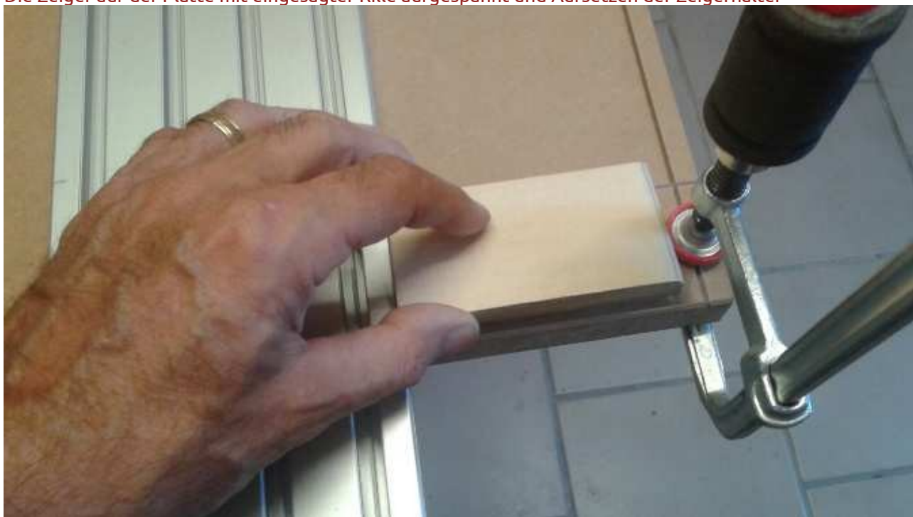
Aufleimen der Deckplatte mit Anschlag
