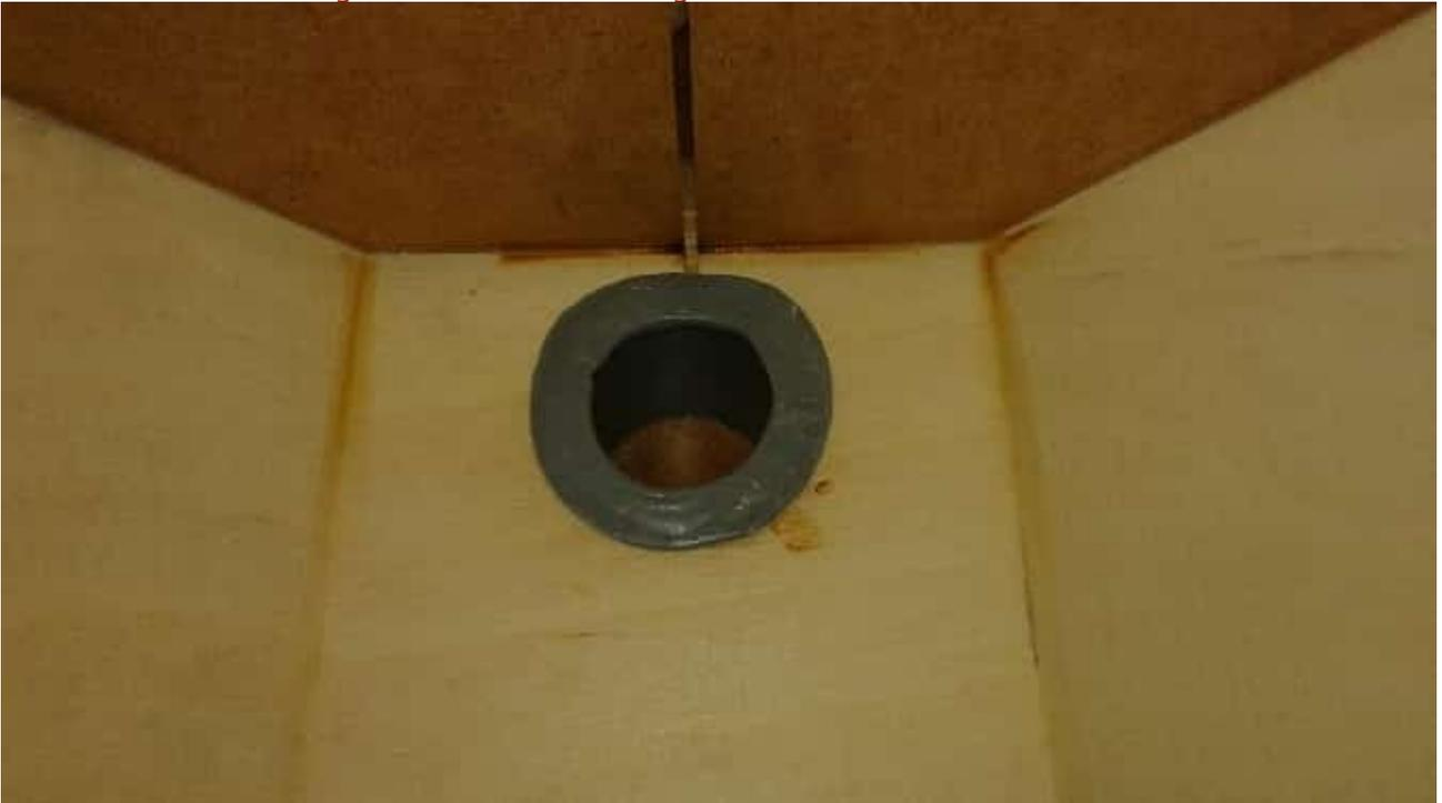
Staubfangkasten lackiert und installiert und Abzweigung mit Schlauch verbunden
