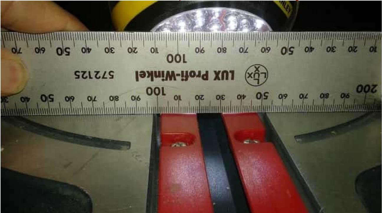
Die Lösung ist einfach, ein neuer Einsatz aus 9mm Multiplex der dann mit der Säge selbst eingeschnitten wird.
