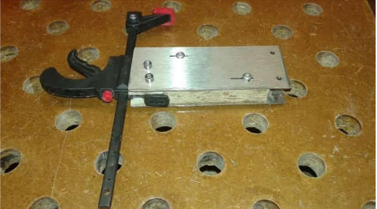
Die Zwinge mit Aufdopplungen wurde am Galgen mit 2 M4 Schrauben festgeschraubt. Für den Andruck wird einfach der feststehende Andruckteil der Zwinge verwendet die für diese Anwendung in der Spreizkonfiguration verwendet wird.
