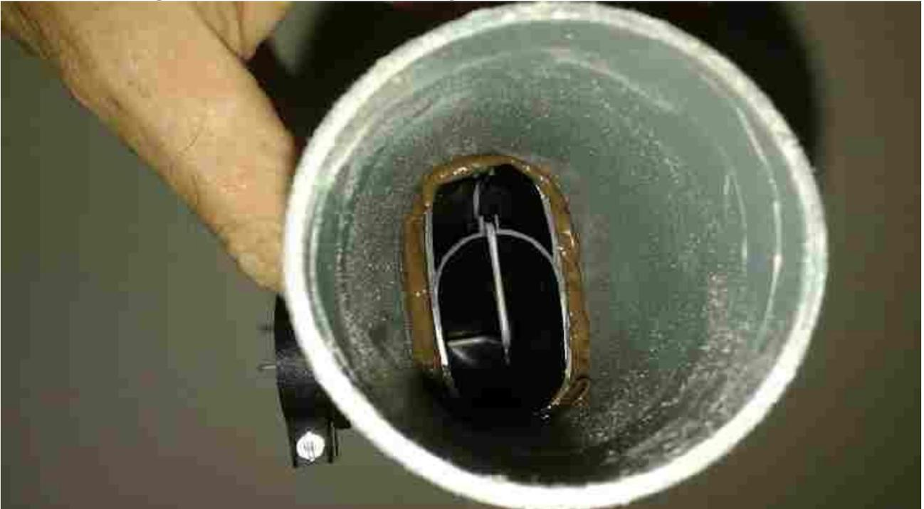
Der fertige 50mm Winkeladapter mit Silikondichtung und Halteschrauben
