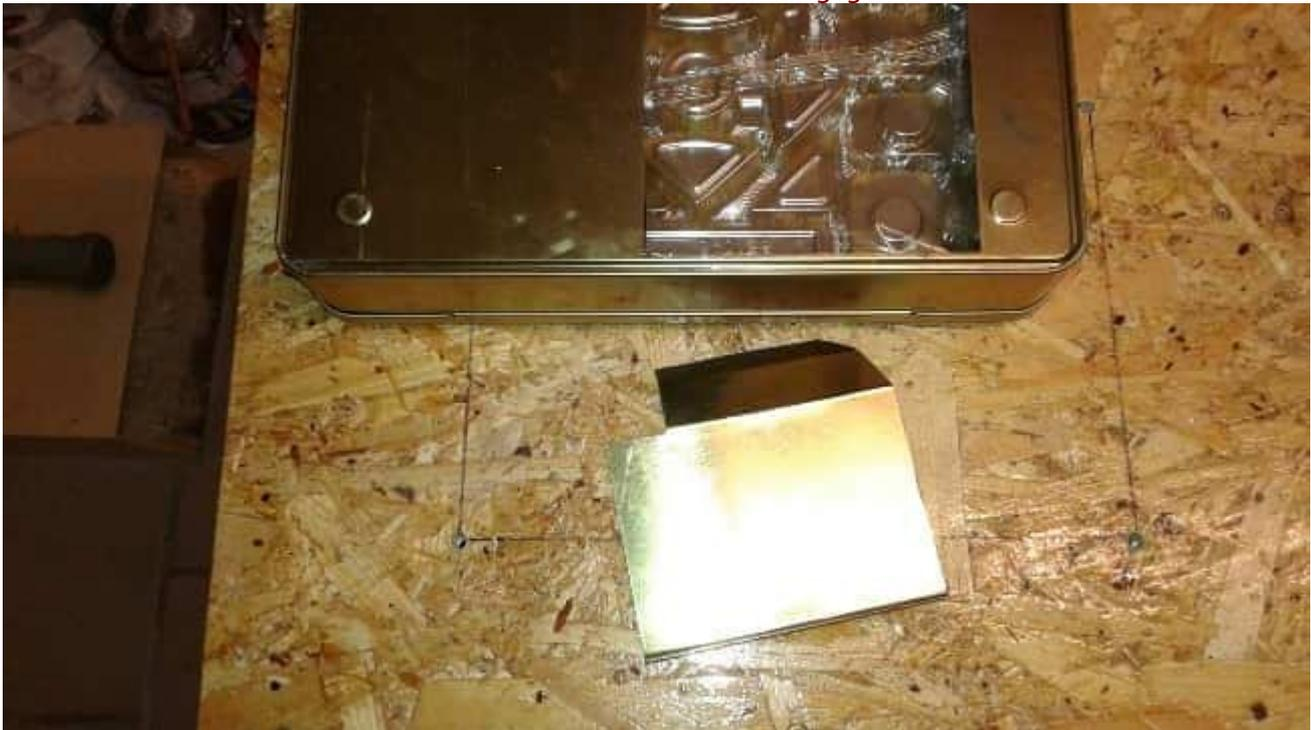
Schutzschild mit Epoxy eingeklebt.
