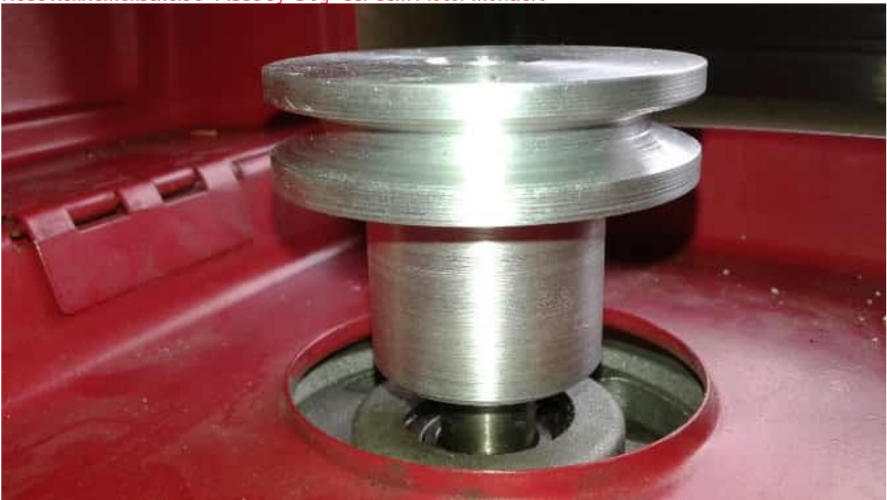
Neue Keilriemenscheibe "Made by -Dog-" auf dem Motor montiert
