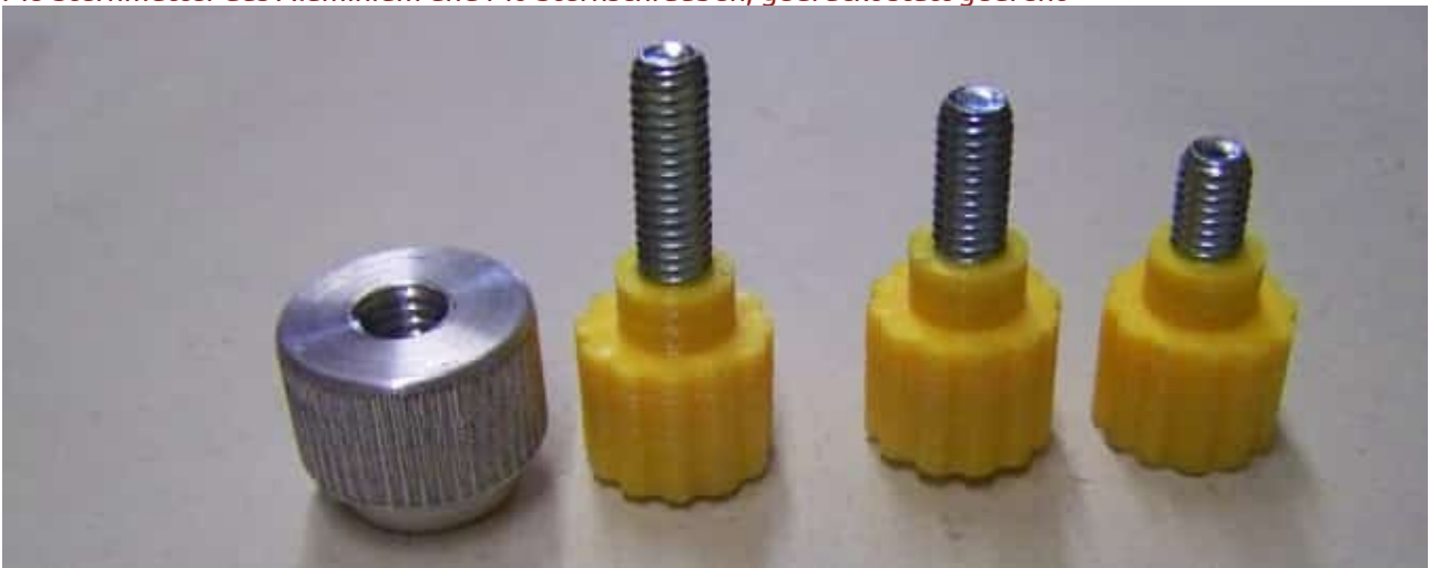
M8 Sternmutter aus Aluminium und M6 Sternschrauben, gedruckt statt gedreht
