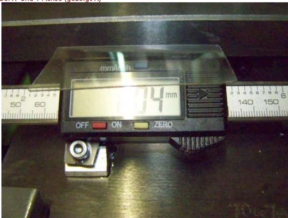
Spanschutz bei X- und Y-Achse (gezeigt X)
