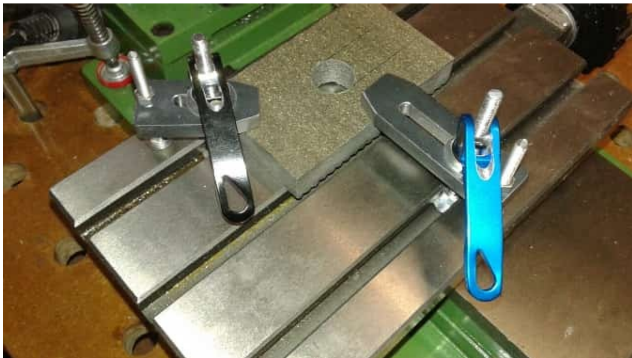
Werkstück mit Eigenbau-Spannpratzen festgelegt
