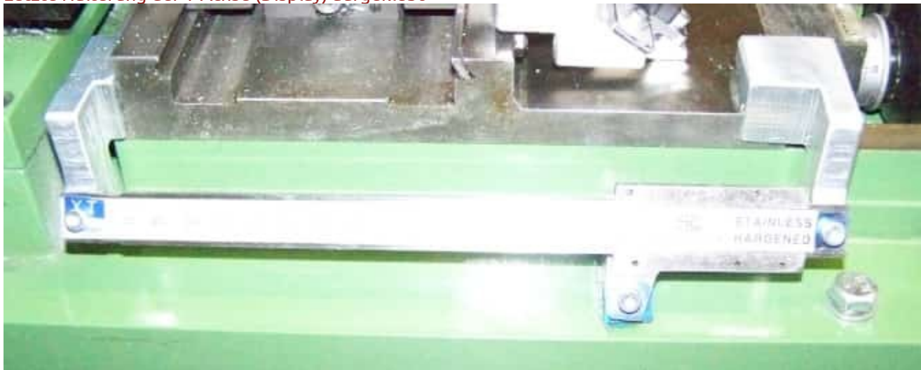
Letzte Halterung der Y-Achse (Display) aufgeklebt
