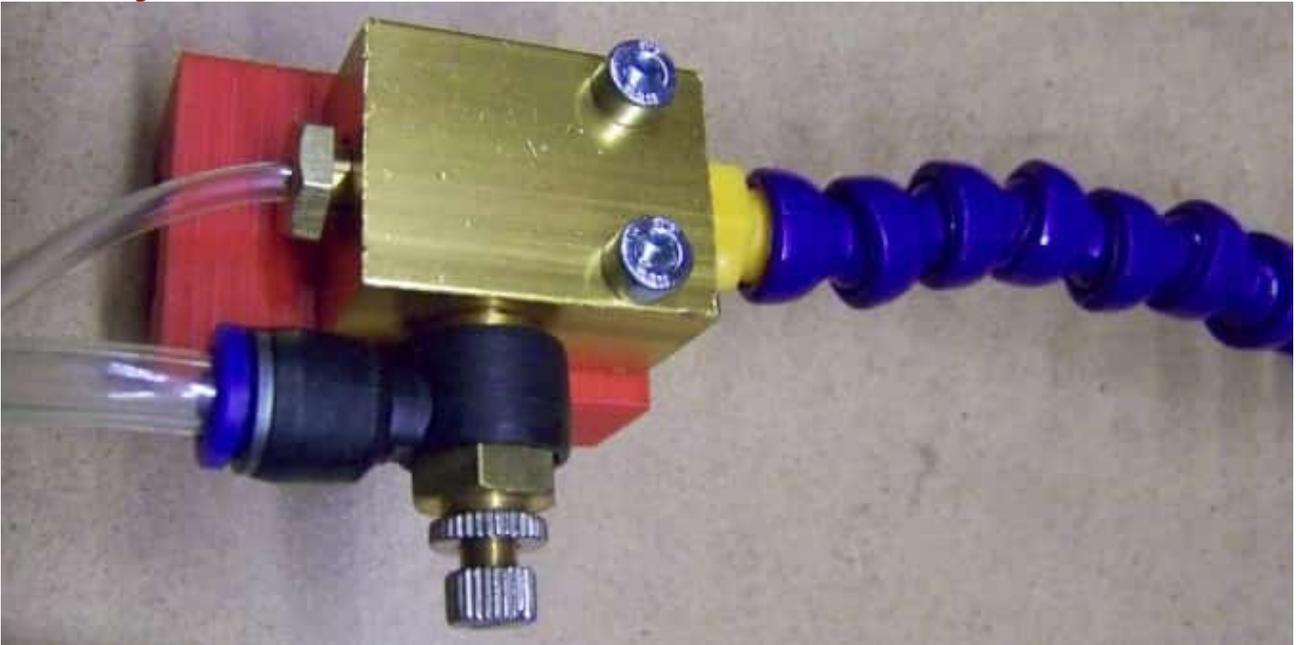
Das Teil auf den QCTP aufstecken, Druckluft und Ölflasche anschließen. Den Hals so ausrichten daß er über dem Werkstück und auf der Position des Drehmeißels sitzt und es kann losgehen.
