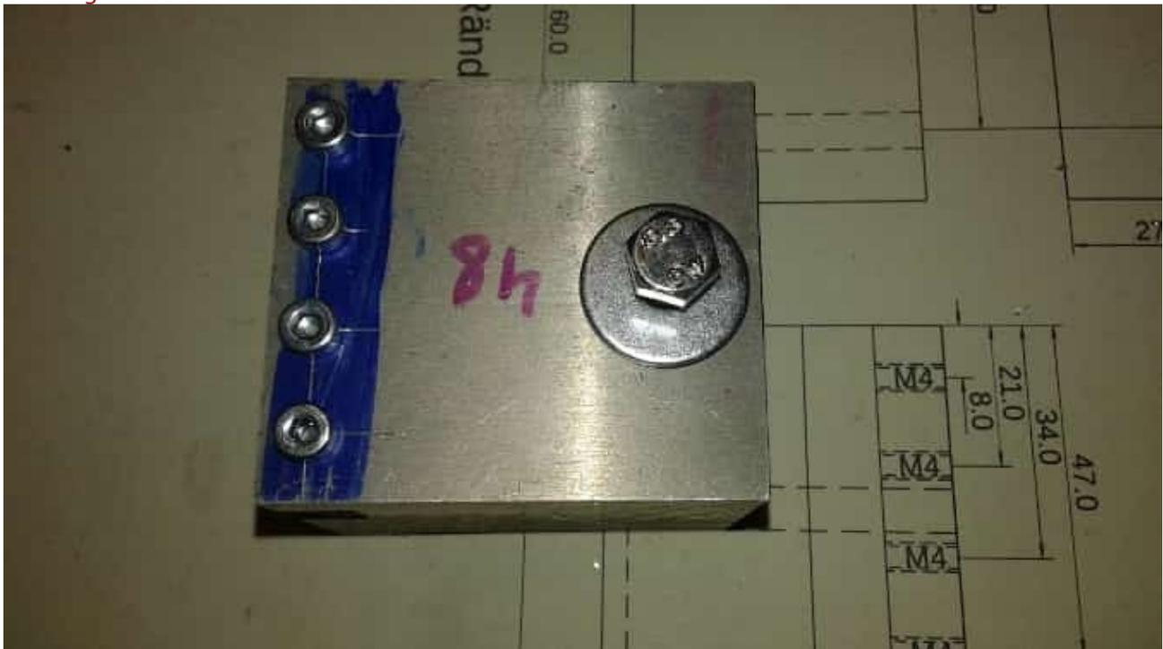
Noch kurz alle Kanten und Ecken etwas gebrochen und fertig ist das Ding.
