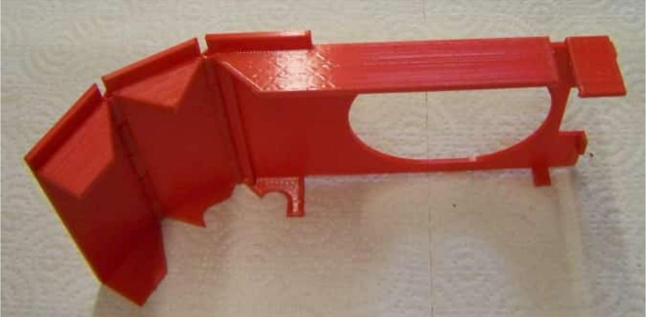
Das Ganze wird übergestülpt und der Haken an der vorderen Ecke rastet am Quersupport ein.
