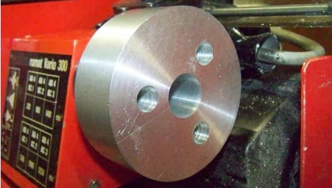
Es folgte das Drehen der Auflagefläche wobei für die Passung des neuen Futters zuerst nur auf etwa 56mm abgedreht wurde.
