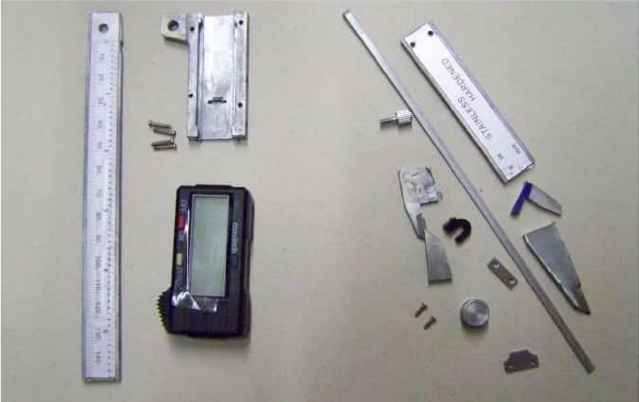
Manche dieser Edelstahl (oder Ekelstahl?) Meßschieber lassen sich selbst mit HSS-E Bohrern nicht bohren. Entweder man hat VHM Bohrer oder man schleift sich Steinbohrer wie einen Metallbohrer an. Mit ihren HM Plättchen gehen sie dann durch wie durch Butter. Dies hatte ich schon einmal als Tip beschrieben und den habe ich hier auch wieder ganz dringend gebraucht.
