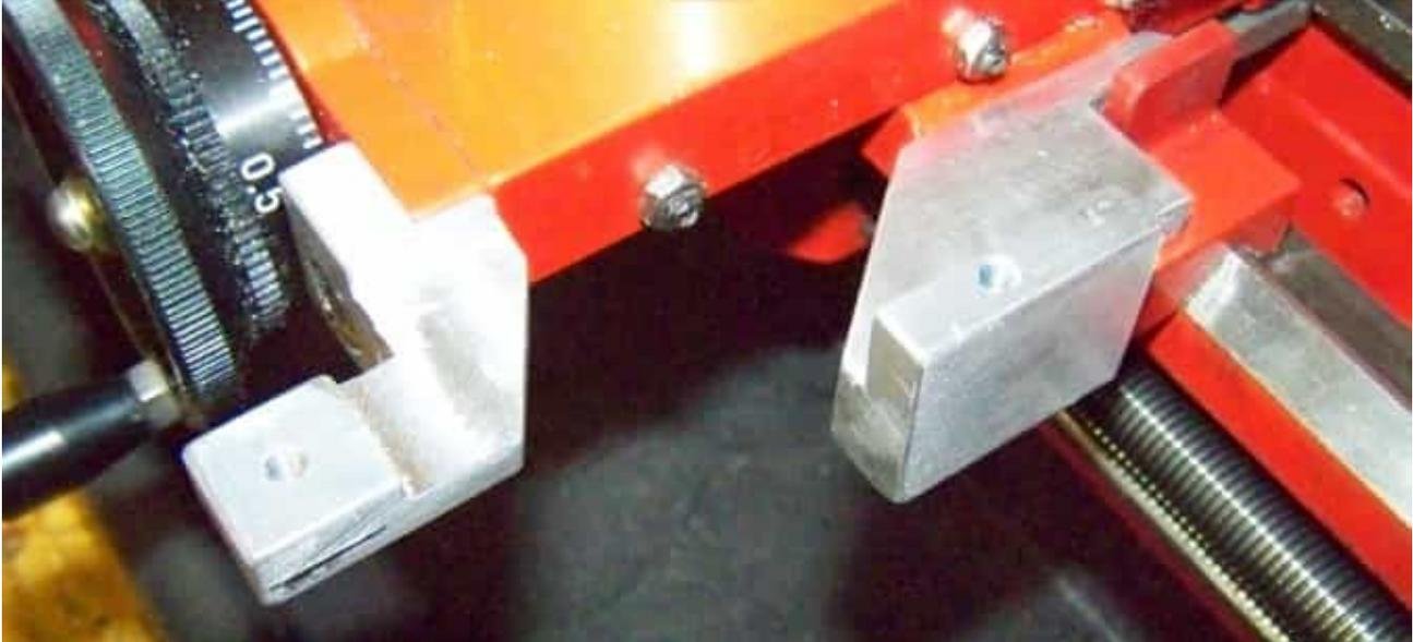
Zuletzt noch Schiene und Display mit M4 Inbusschrauben anschrauben und fertig zum Test.
