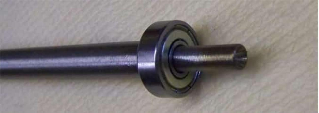
Nun wird der Stab umgedreht und das noch rohe Ende das nun auf der Reitstockseite ist wird ebenfalls passend zum Kugellager abgedreht. Hier braucht man keinen oder minimalen Überstand.
