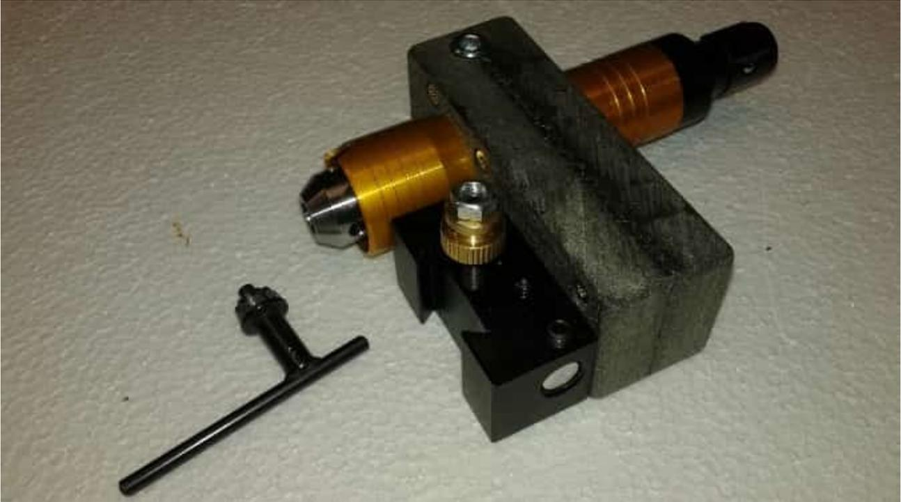
**Hinweis:** sowohl die Halteplatte als auch den Bohrkopf kann man in beiden Richtungen verwenden/montieren wodurch man die Bohrvorrichtung optimal passend für die jeweilige Anwendung anordnen kann.
