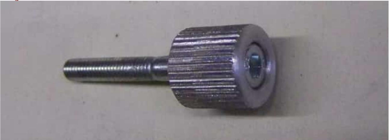
Nun nur noch Schiene und Anschlag mit der Rändelschraube verbinden und fertig ist der neue Anschlag.
