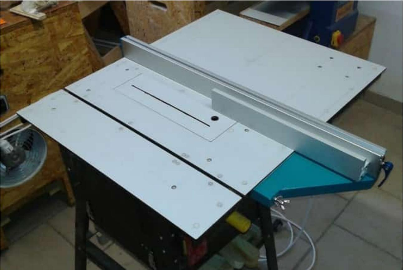
Brennholzsäge zur verwendbaren Tischkreissäge aufgewertet
