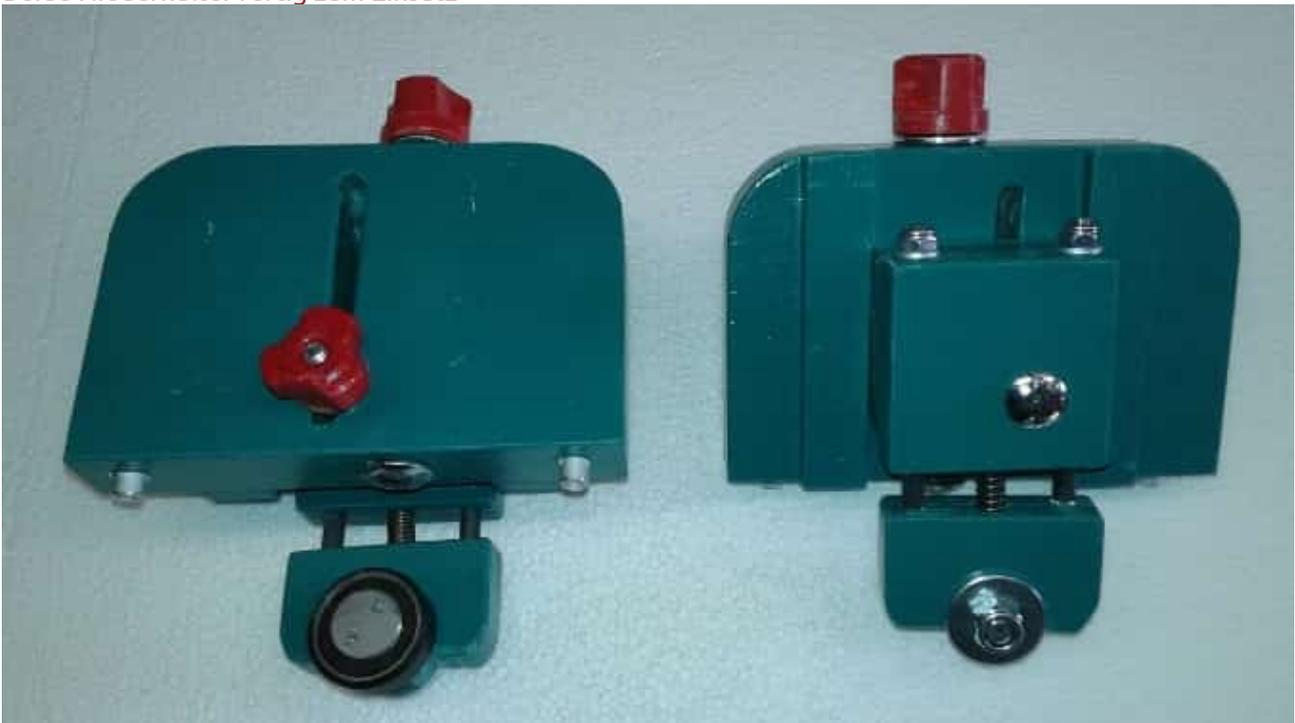
Die Niederhalter sollten so auf das Werkstück aufgedrückt und dann festgelegt werden daß der bewegliche Teil 1-3mm eingedrückt wird. Damit können auch Unterschiede in der Werkstückdicke ausgeglichen werden.
