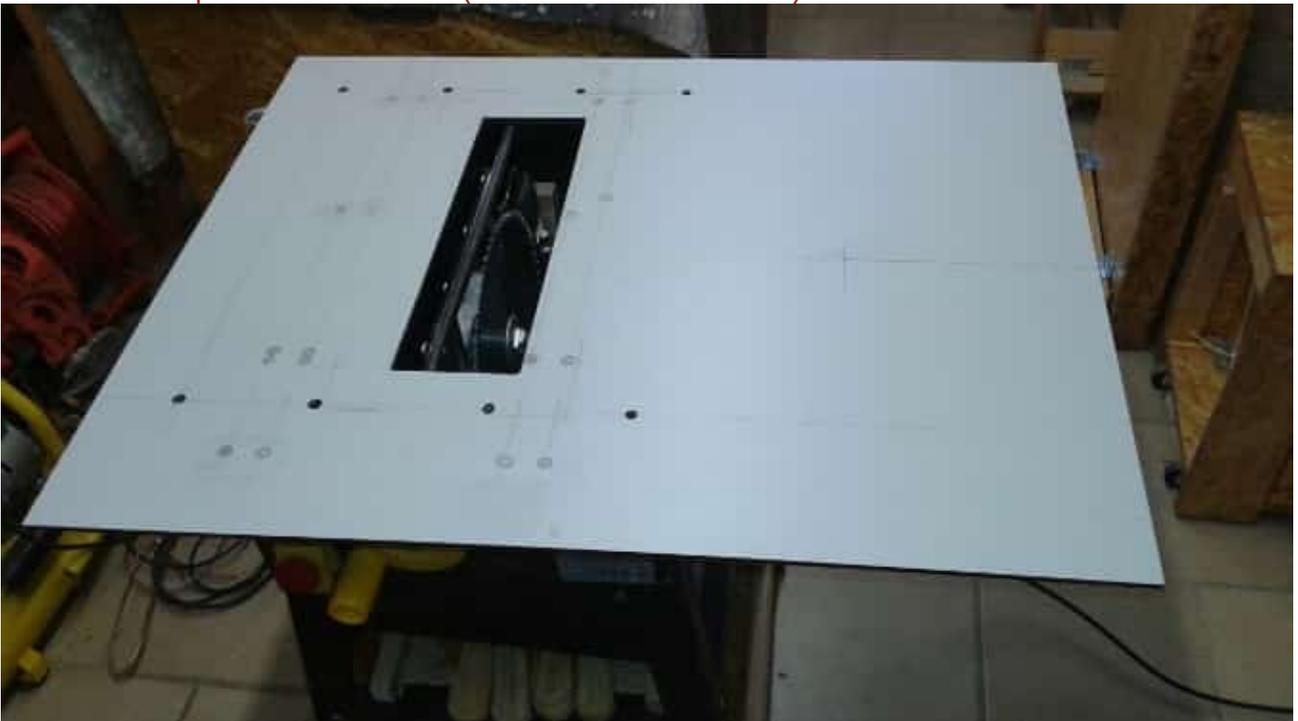
Wo es ging wurden um den Ausschnitt für die Einlegeplatten noch Streifen von Bauallzweckplatten mit Epoxy darunter geklebt.
