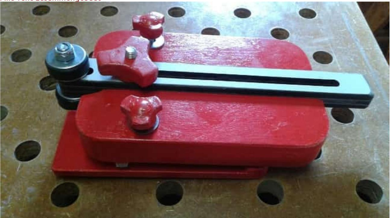
Mit dieser Klemmvorrichtung kann ich den Federkamm auch gleich noch für die Oberfräse im Tisch einsetzen. Bisher hatte ich immer mit den herkömmlichen Federkämmen, ebenfalls Eigenbau, gearbeitet und ich muß neidlos gestehen daß die Idee von YT eine Verbesserung darstellt.
