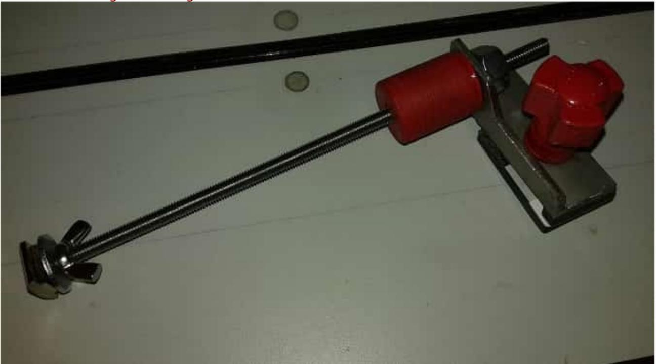
Das ganze Gebilde in die untere Nut einschieben, mit der Klemmung befestigen, die Flügelmutter anziehen und schon kann man fein einstellen!
