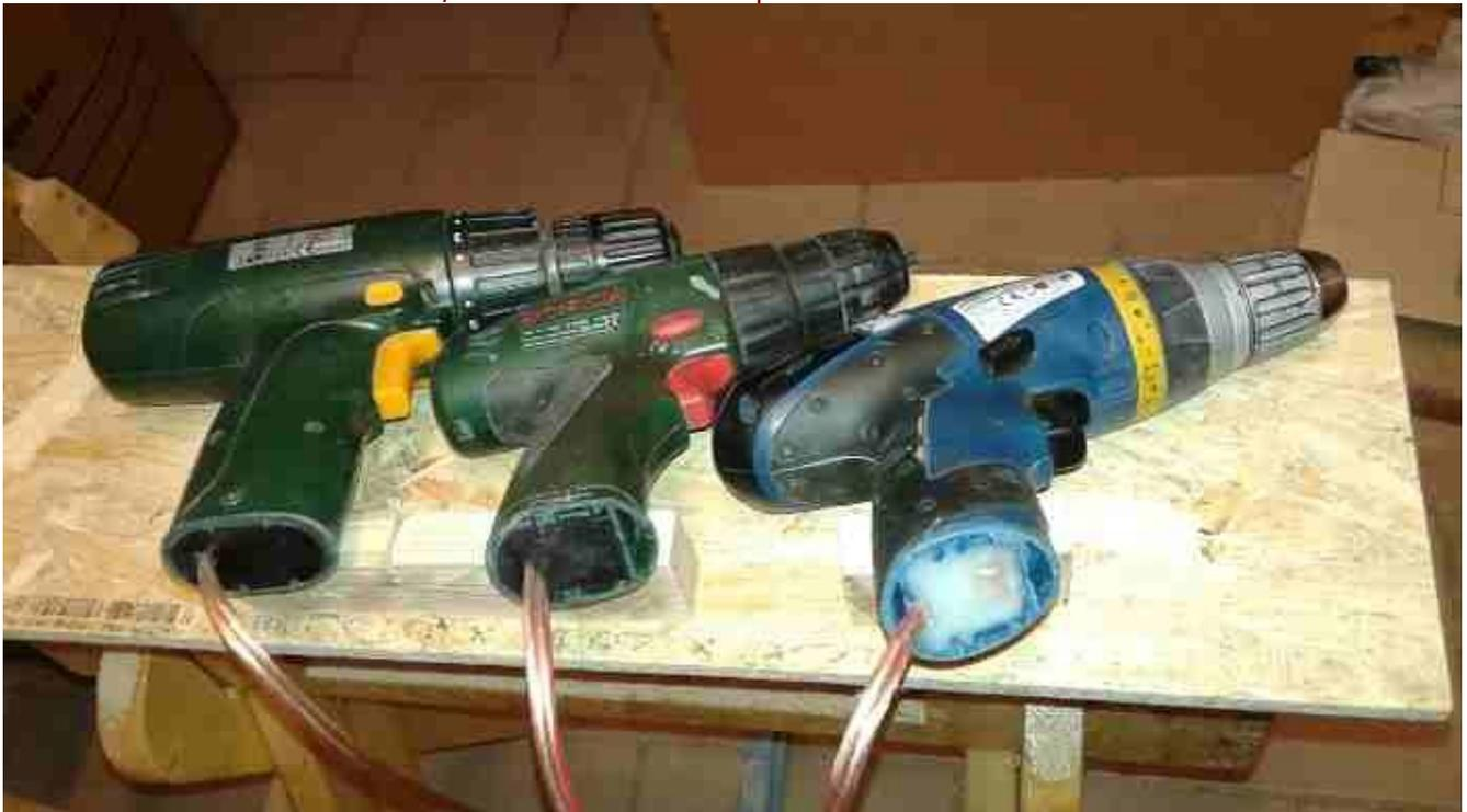
Der Nachzügler, ein Made in Switzerland GSR 9,6. Hier der als Netzteilstecker umgebaute Akkupack.
